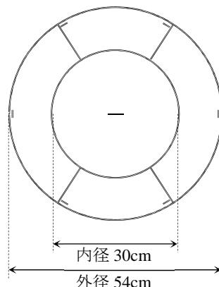
中高生初級部門の仕切板 4 枚は上図の支柱の外側に接するよう設置
